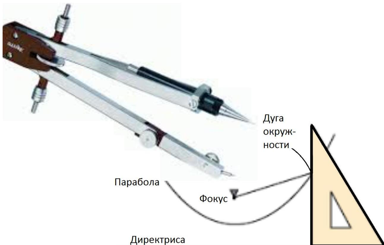
Рис. 1. Построение параболы циркулем и угольником
