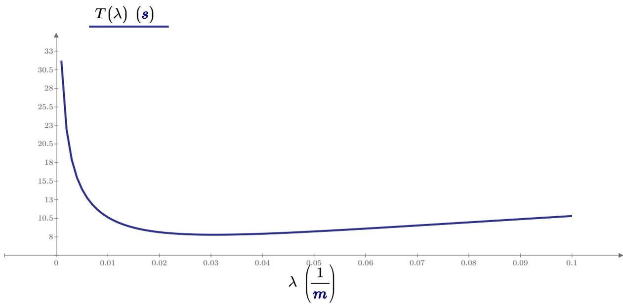
Der optimale Parameter λ, bei dem der Körper am schnellsten unterwegs ist wird numerisch ermittelt:
