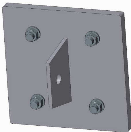
Abbildung 1: Ankerplatte mit angeschweißter Lasche
